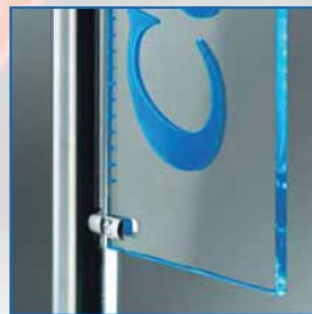
Bei der Gegenüberstellung beider Glasflächen erkennt man, daß die Oberflächen völlig plan sind, da das Glas nur im Glaskörper gelasert ist.
